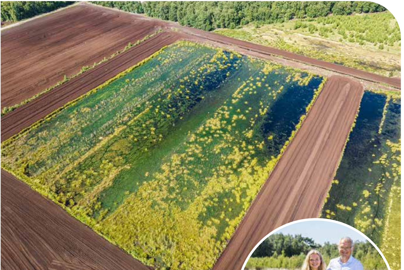
Durch den Einsatz des Ober-Unterfeld-Verfahrens laufen Torfgewinnung und die Moor-Renaturierung parallel. Peat extraction and peatland restoration run in parallel thanks to the use of the Ober-Unterfeld process.
